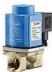
Позиционно управляемые электромагнитные клапаны типа EV251B с электромагнитной катушкой для нейтральных сред рекомендуется использовать в системах отопления и подобных им, где требуется клапан, работающий без перепада давления. Высокая степень открытия при нулевом перепаде давления.
