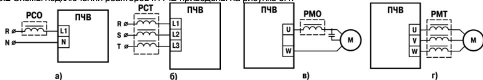
Рисунок 5.1 - Схемы подключения реакторов: а) серии РСО во входных цепях питания ПЧВ с однофазным входом; б) серии РСТ во входных цепях питания ПЧВ с трехфазным входом; в) серии РМО в выходных цепях ПЧВ для питания однофазных электродвигателей; г) серии РМТ в выходных цепях ПЧВ для питания трехфазных электродвигателей.
