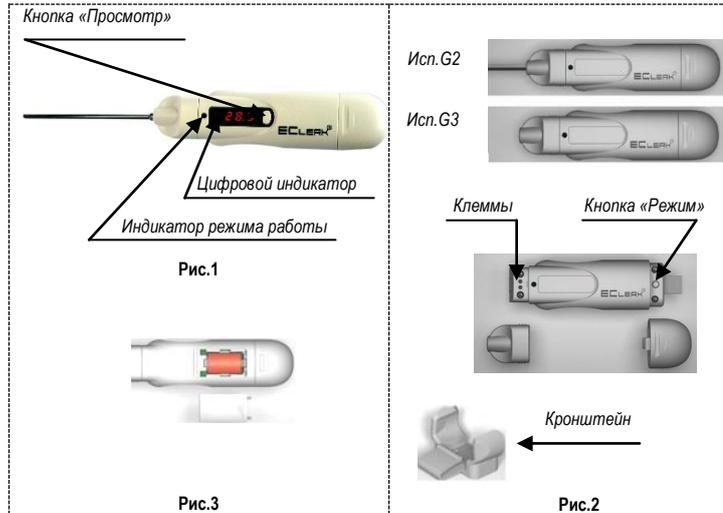
В зависимости от наличия или отсутствия цифрового индикатора и внутренней памяти прибор имеет следующие модификации:
