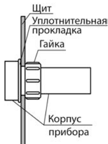
Рисунок 5.1 – Монтаж прибора в щит
