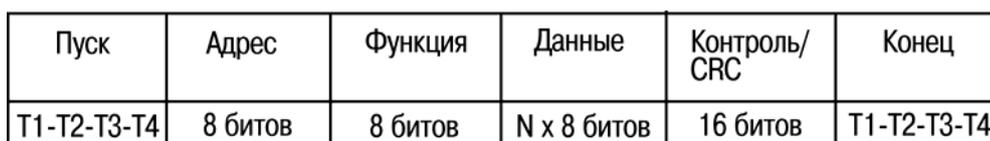
**Рисунок 4.4 – Типичная структура сообщения Modbus RTU**
