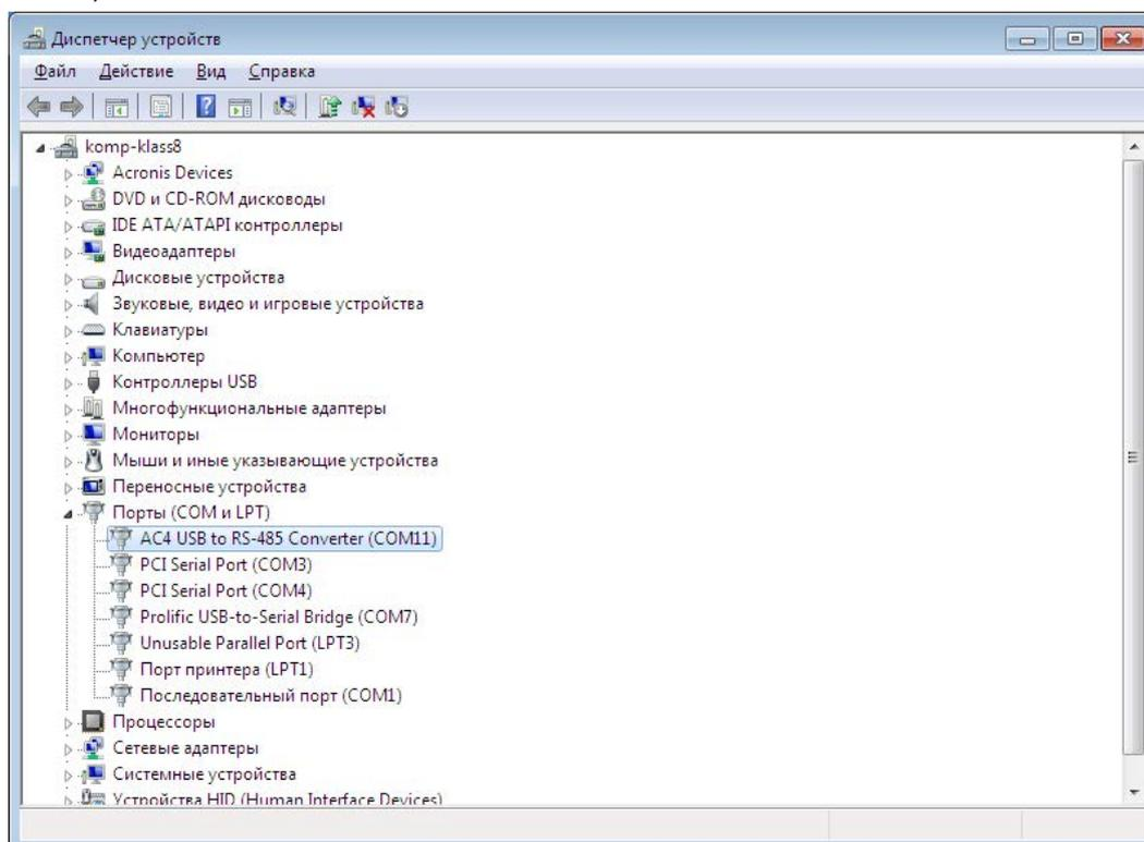
**Рисунок 5.3 - Преобразователь интерфейсов АС4 в Диспетчере устройств**
