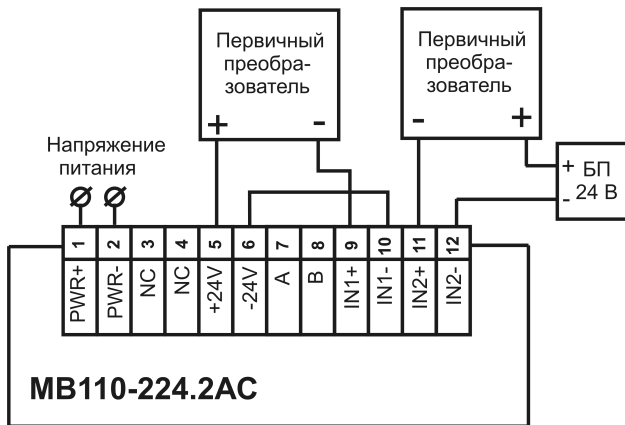
Рисунок Б.2 – Подключение к прибору двухпроводных первичных преобразователей
