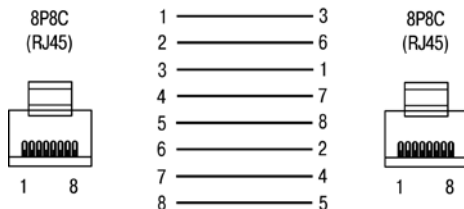
Рисунок В.7 – Кабель Ethernet crossover
