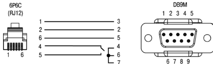
Рисунок В.2 - Схема кабеля КС3 для подключения модема к ПЛК154 по интерфейсу RS-232
