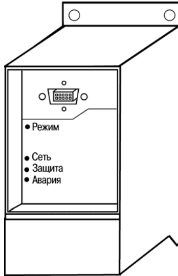
Рисунок 3.2 – Лицевая панель прибора. Отсек подключения ЛПО
