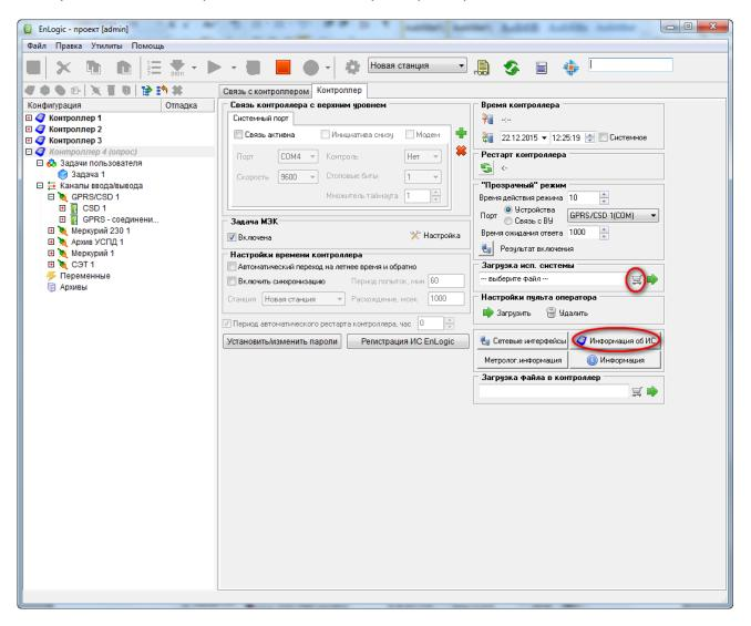
Прочитать и зафиксировать текущую версию программного обеспечения ПЛК323-ТЛ (кнопка **Информация об ИС контроллера**), затем в группе **Загрузка исп. системы** нажать кнопку выбора файла прошивки.
