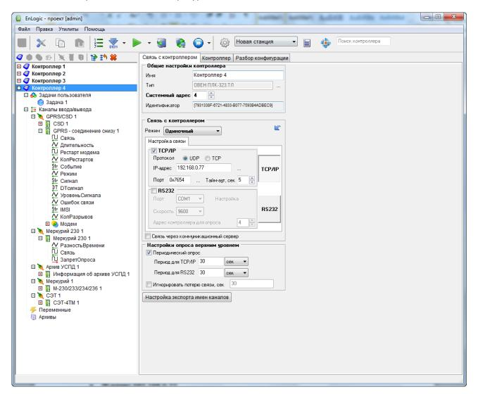
Замечание. В одной конфигурации EnLogic можно хранить настройки многих ПЛК323-ТЛ. Желательно располагать конфигурации EnLogic в отдельных подкаталогах, так как одна конфигурация состоит из нескольких файлов.
