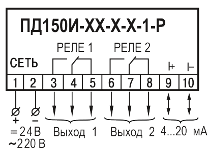
Рисунок 5.2 – Назначение контактов клеммника преобразователя с аналоговым выходом
