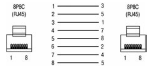
Рисунок В.4 – Кабель Ethernet crossover
