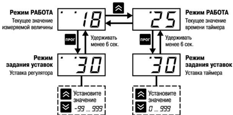
Рисунок 4.3 – Схема задания уставок регулятора и таймера
