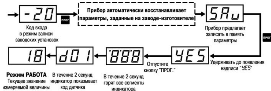
Рисунок 4.2 – Схема действий при восстановлении заводских установок
