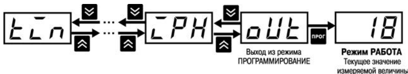
Рисунок 4.5 – Схема переключения между параметрами группы
